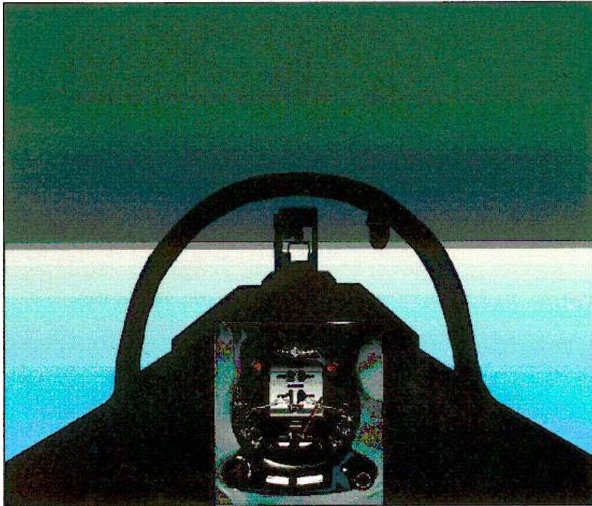
Рис. 4. Верхняя часть петли Нестерова с индикатором типа АГД
