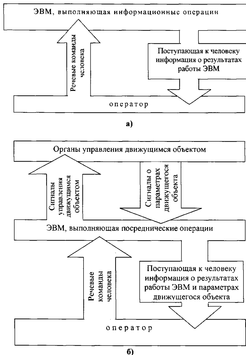
Рис. 1 Типы речевого взаимодействия человека с техникой: а) первый тип; б) второй тип
