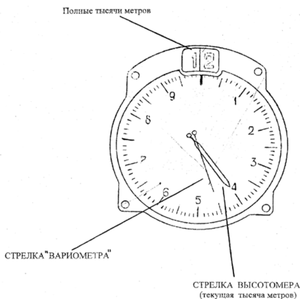
Рис. 3 Однострелочный высотомер, дополненный стрелкой вариометра
